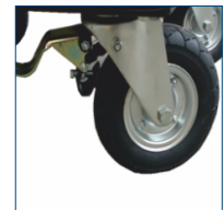
Koła pneumatyczne, ułatwiające transport wentylatora
